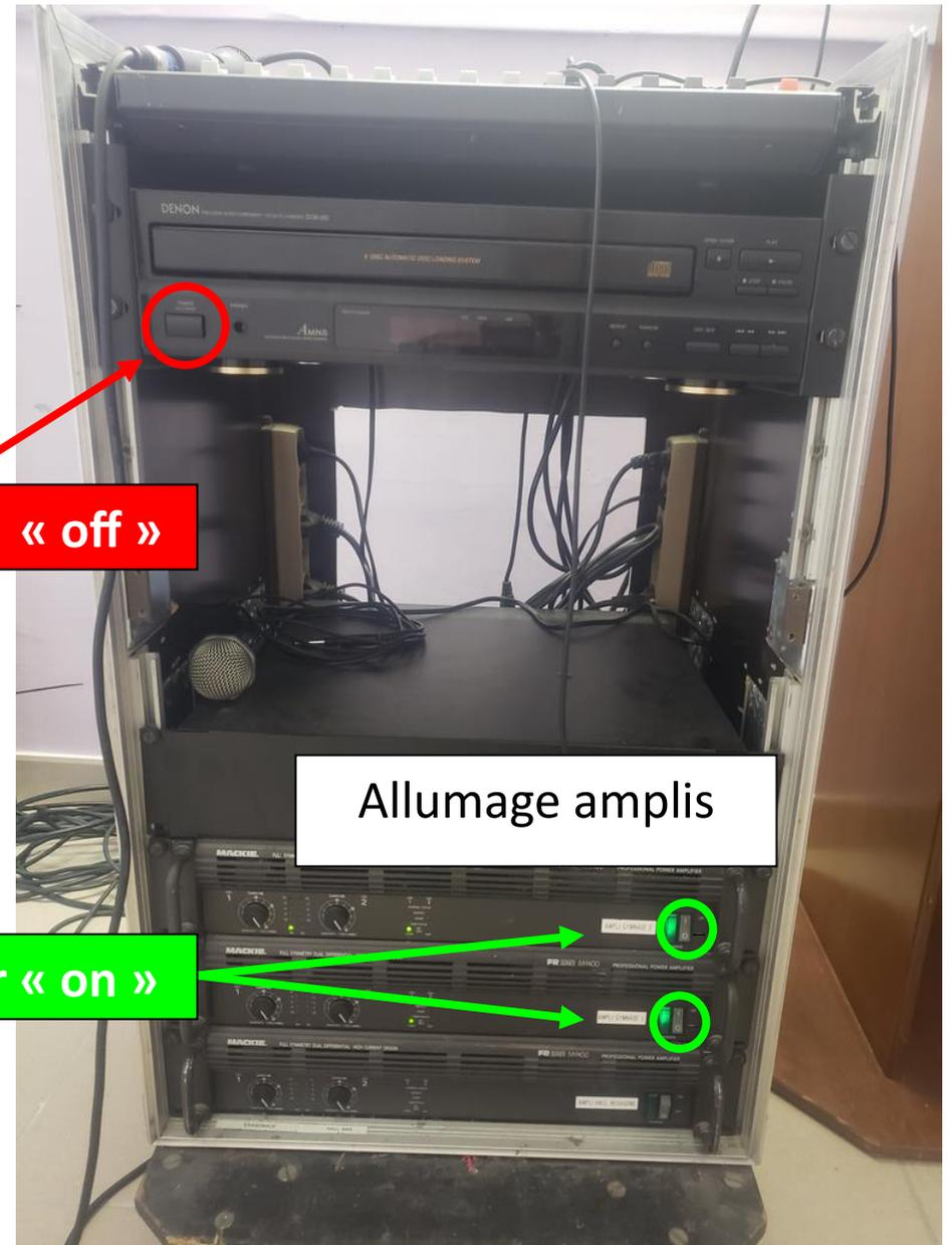
Procédure inverse pour l'extinction en laissant refroidir les amplis avant de débrancher
